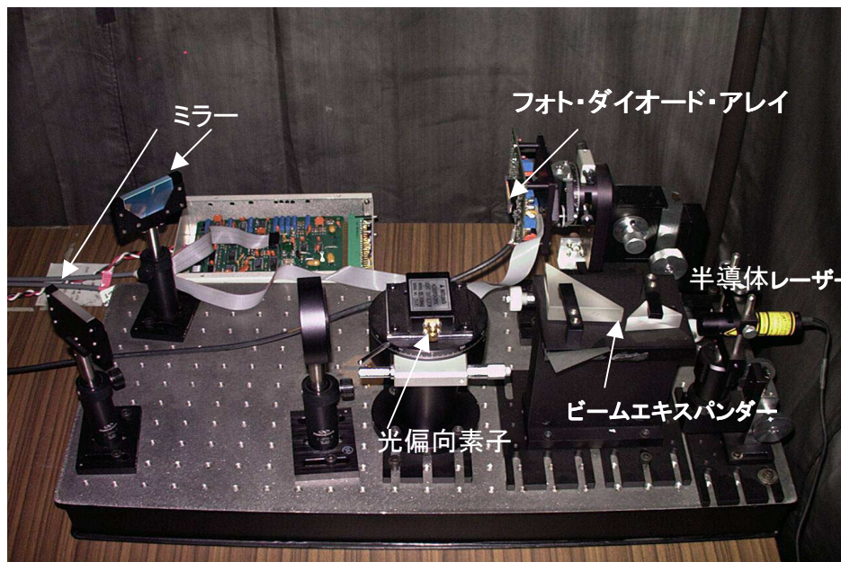
今回鹿島34mのバックエンドに設置されたAOSの光学系
