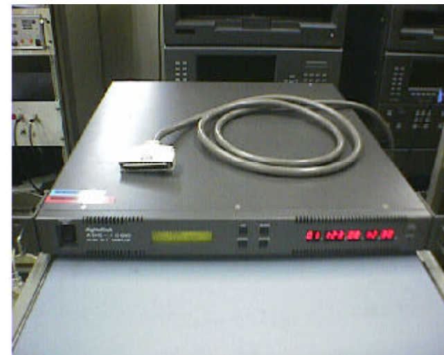
図1: ADS1000ギガビットADサンプラ、時系、安定度に忠実、VSIインターフェース、ether-ne制御を備える。サンプリングビット分布表示など、これまでのADに無い機能も盛り込んだ。
