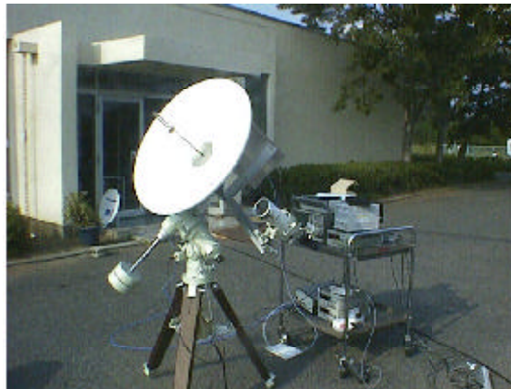
図1:キャラバン電波望遠鏡、小型赤道儀に コリメーション用の光学望遠鏡と同架されている。
