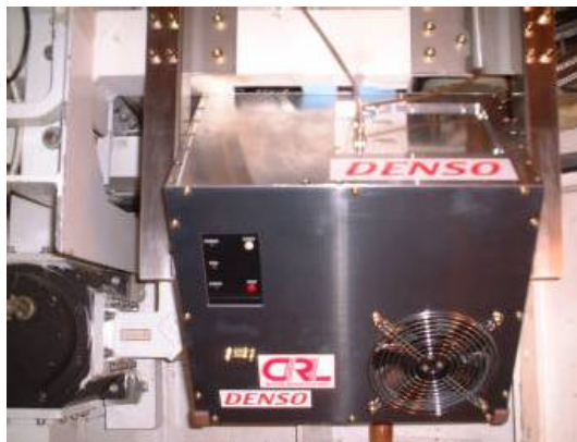
HTSフィルタサブシステム。HTSフィルタユニットを70Kまで冷却する小型の冷凍機が内部にある。
