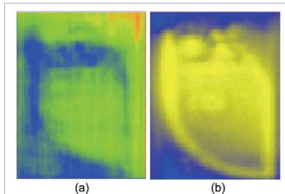
図9 60 GHz による Suica の(a)透過(b)反射イメージング結果
