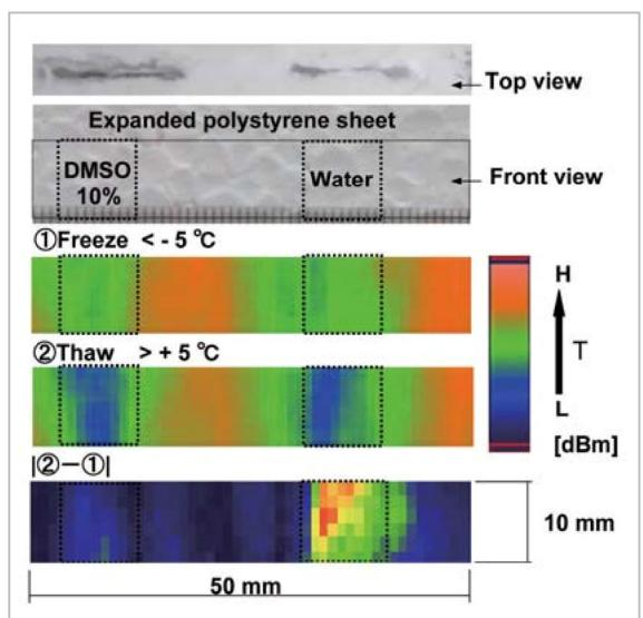
図 10 水と DMSO 溶液のイメージング結果
