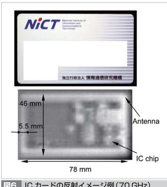
図6 ICカードの反射イメージ例(70 GHz)
