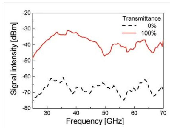
図2 透過イメージングにおける信号強度
