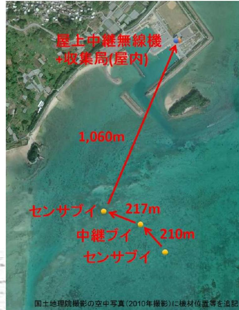
SUN無線機搭載センサブイと設置の様子
