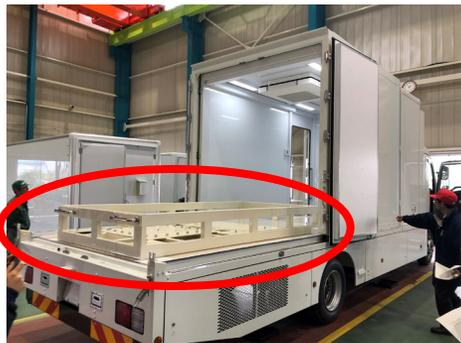
免震床には望遠鏡と精追尾光学系が設置される
