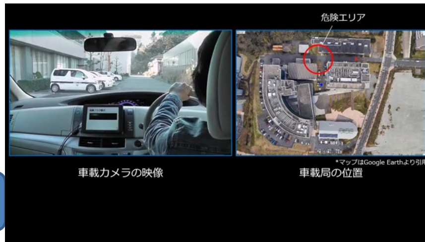
システム実証(危険エリアへの車両接近を通知、移動局A設置カメラ)
